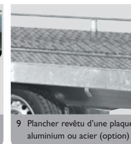
9 Plancher revêtu d'une plaque aluminium ou acier (option)
