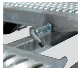
4 Système de verrouillage des rampes
