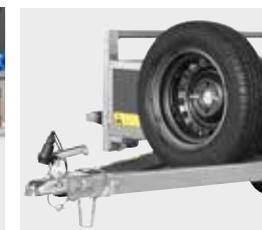
6 Roue de secours / Support roue de secours (option)
