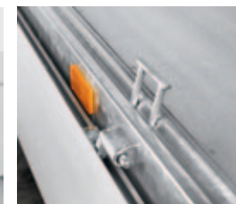
6 Crochets profilés intégrés (de série)
