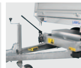
3 Pompe électrique et manuelle
