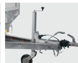
8 Roue jockey automatique (de série sur toutes les bennes)
