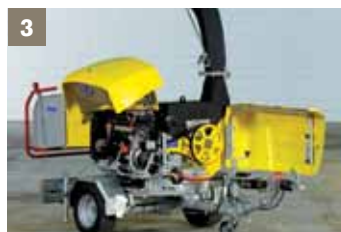
1 - MOTEUR KUBOTA V1505 35 CV / 26,2 kW – 4 Cyl.
